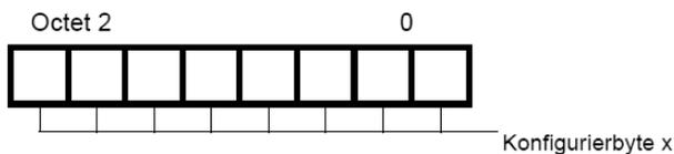
Aufbau eines Octets im Konfiguriertelegramm:
