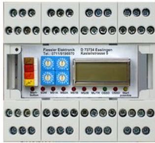
PLSG3K_RP im Schaltschrankgehäuse
