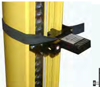
Säulenmontage Gummiband nur an einer Schraube befestigen
