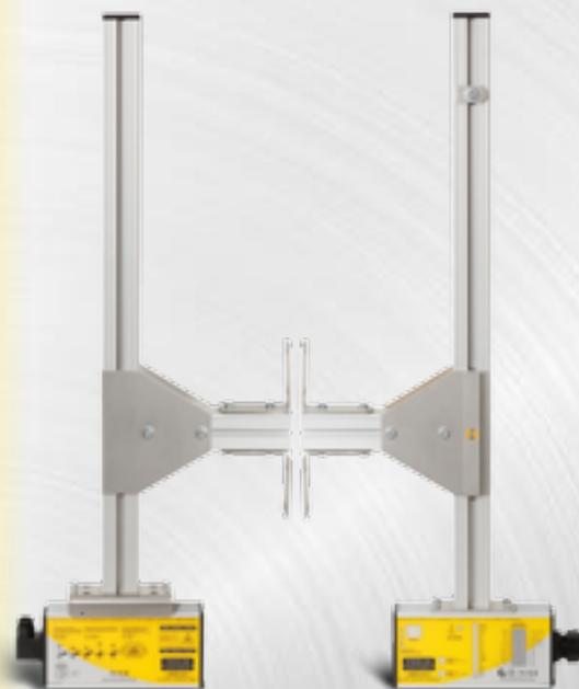
L'émetteur AKAS® et le récepteur AKAS® sont fixés, dans cette version, sur un support AKAS® LC réglable manuellement.
