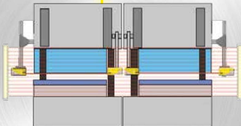
Si toute la largeur de la machine est nécessaire, les outils de pliage seront alors montés sur toute la longueur de pliage. Les AKAS® sont alors désactivés et escamotés.
