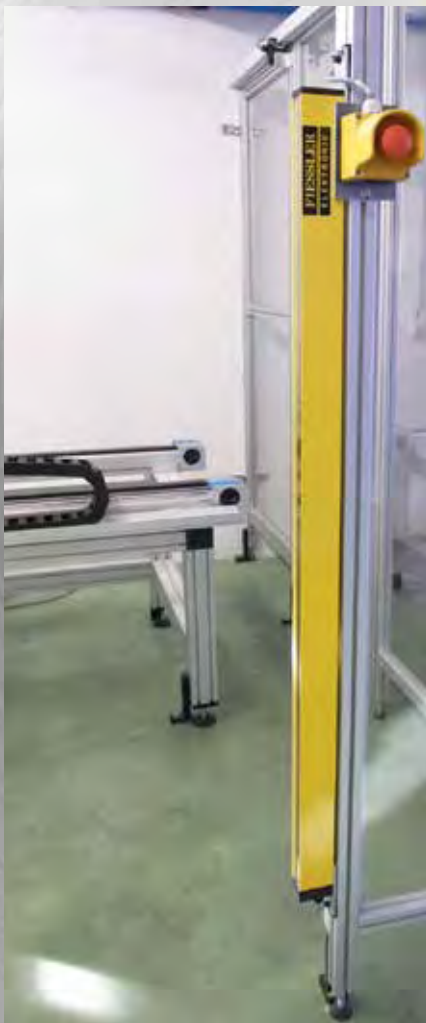
Beispiel 2-strahlige normgerechte Zugangssicherung / Bereichsabsicherung mit ULVT 500/2
